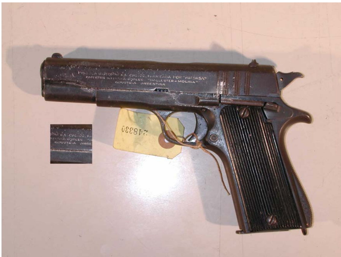
Pistola "HAFDASA" Ballester Molina calibre .22 (aunque transformable a calibre .45), producida en Argentina hasta final de los años 50.
